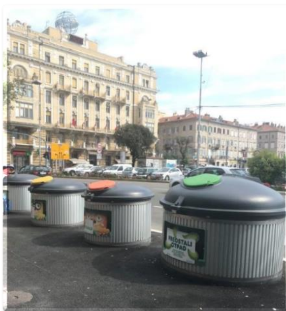
Slika 3. Poluukopani spremnici na lokaciji Riva 4
